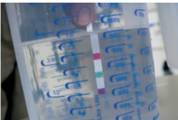
Тестовые полоски изменяют свой цвет в том случае, если концентрация хлора превышает 1 ppm.
